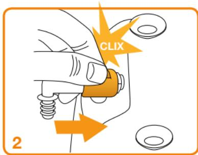
Sicherungsschieber auf **OFF** stellen, Anschluss auf Zulauf-stutzen des NU® stecken und anschließend den Schieber in die Stellung **ON** bewegen, um somit die Verriegelung zu aktivieren.
