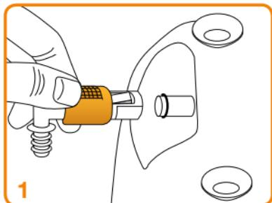
Beiliegenden Anschluss-schlauch am Gerät befestigen.
